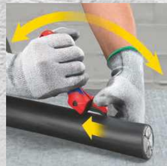
Funkcia račně umožňuje odizolovanie s väčšou účinnosťou a menšou námahou
