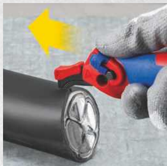
Pre tlačenie alebo ťahanie: Dve strany čepele pre pozdĺžne rezanie
