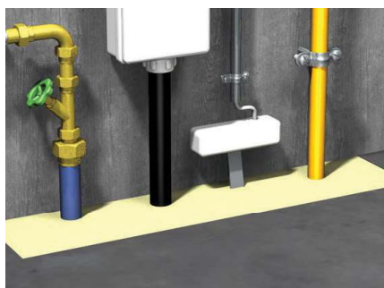
Zmiešané prestupy rozvodov
